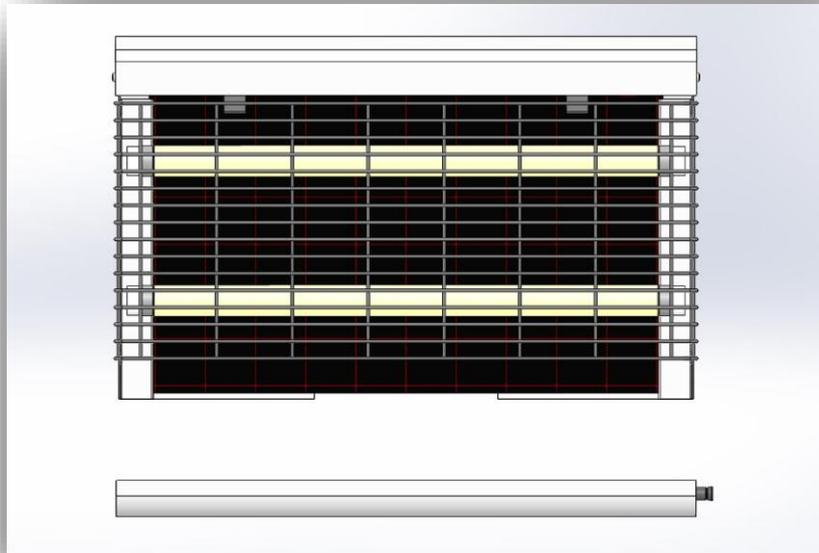
3. Empuje la placa adhesiva en la pista debajo de los tubos
